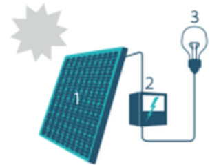
1. Zonnepaneel | 2. Omvormer 3. Elektrische toestellen
